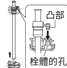
請留意不要弄錯栓體的安裝方向，精準地將栓體嵌入。將凸部對準栓體的孔。
