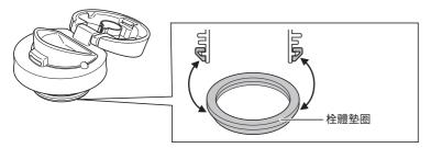
按住栓體墊圈邊緣,將其緩慢卸下。安裝栓體墊圈時,確保其沿正確 方向完全嵌入就位。 MJCA
