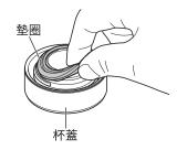
拆下時,請捏住墊圈的邊緣, 慢慢拆下。
